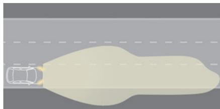
Los faros y los módulos crean un cono de luz con un haz más elevado, adecuado para las vías rápidas.
