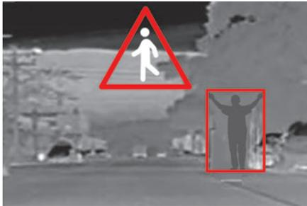
El rango de detección de la cámara está comprendido entre 15 m (para peatones) y 200 m, según las condiciones de visibilidad.
