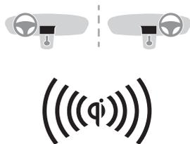
Este sistema permite la carga inalámbrica de dispositivos portátiles, como un smartphone, mediante el principio de inducción magnética conforme a la norma Qi 1.1. El dispositivo portátil que se va a cargar debe ser compatible con la norma Qi, por su propio diseño o empleando un estuche o una carcasa compatible. También se puede utilizar una alfombrilla si está aprobada por el fabricante. El área de carga está identificada con el símbolo Qi.
