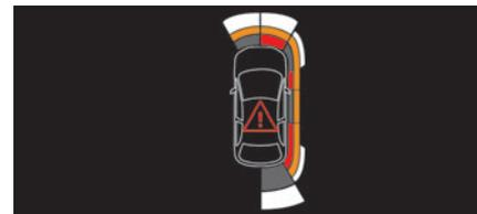
Con cuatro sensores adicionales situados a los lados de los parachoques, el sistema registra la posición de los obstáculos durante la maniobra y los señala cuando se encuentran a los lados del vehículo.
