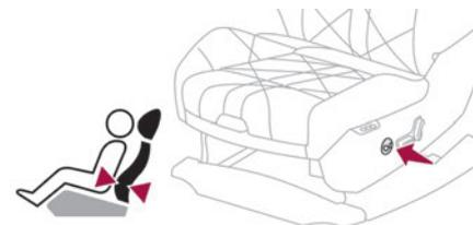
El mando permite ajustar independientemente la profundidad y la altura del apoyo lumbar.
