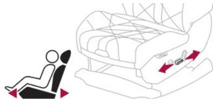
► Empuje el mando hacia delante o hacia atrás para deslizar el asiento.
